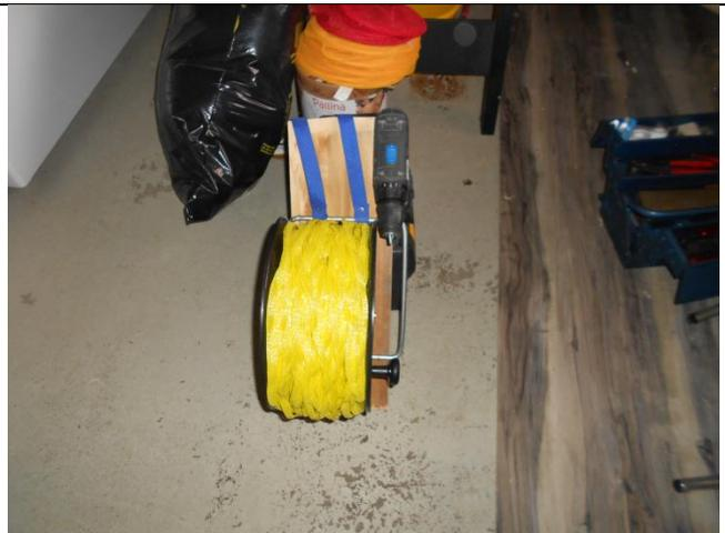
Die Bohrmaschine befestige ich so auf den Haspel, indem ich in das Holzbrett eine Einbuchtung mache, damit ich den Griff der Bohrmaschine in die Einbuchtung legen und mit einer kleinen Holzplatte fixieren kann, damit die Drehkurbel mit dem Fahrradschlauch daran den Haspel zum Drehen bringt. Das Holzbrett lackiere ich noch mit brauner Farbe, damit das Holz nicht faul oder grau wird.
