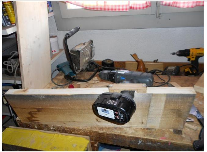
Durch die Umdrehungen der Bohrmaschine dreht sich der Haspel und rollt das Zaunband auf. Damit das Zaunband beim Aufrollen die richtige Richtung aufnimmt, muss die Bohrmaschine im Uhrzeigersinn laufen.
