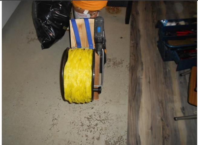
Damit ich den Zaun abrollen kann und die Bohrmaschine nicht nass wird, muss ich erstens die Bohrmaschine entfernen können und zweitens muss ich die Bohrmaschine vom Haspel wegkippen können.
