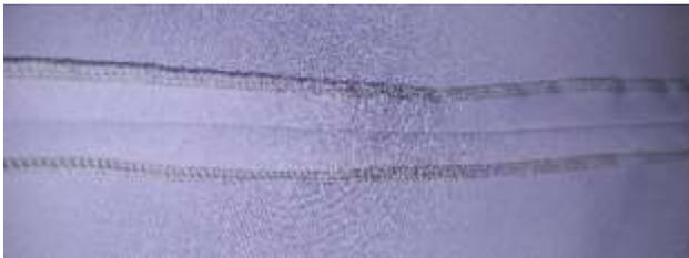
Abbildung 61: Overlock-Naht
